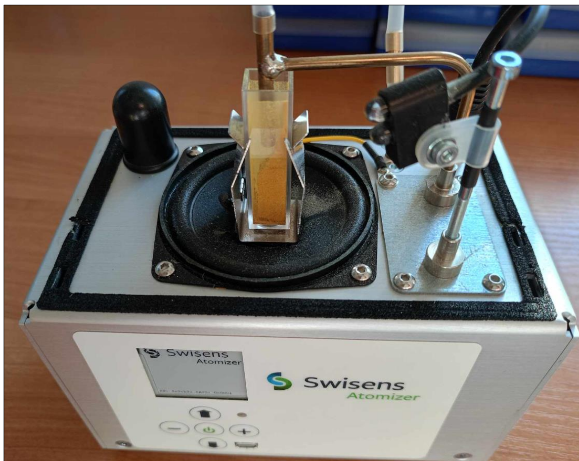
Swisens Poleno Atomizer z próbką zebranych ziaren pyłku brzozy.
